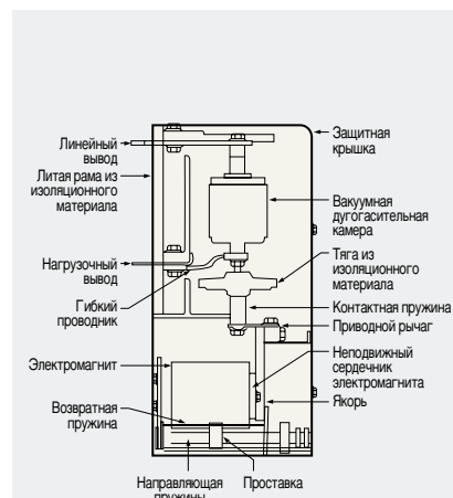
Главный контактный механизм
